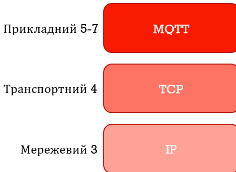
Рисунок 4.1 - Рівні протоколу в моделі OSI
