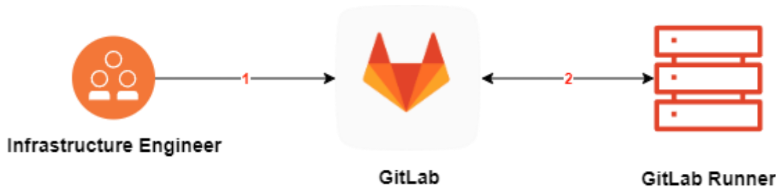
Рисунок 2.3.1 – «Схема взаємодії між інженером інфраструктури та сервісом GitLab»
