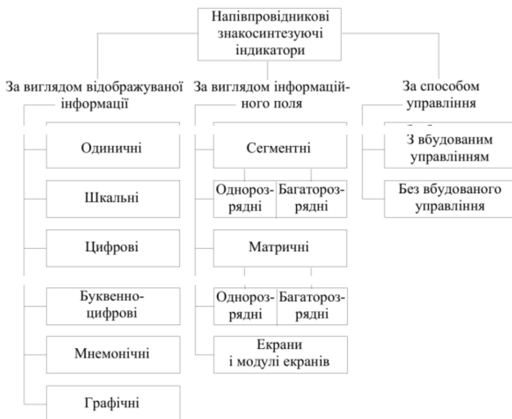
Рисунок 1 – Класифікація сучасних напівпровідникових індикаторів
