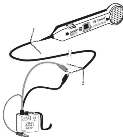
Рисунок 3 - Ідентифікація пари на зворотному кінці кабелю за допомогою індуктивного щупа Greenlee 200EP-G
