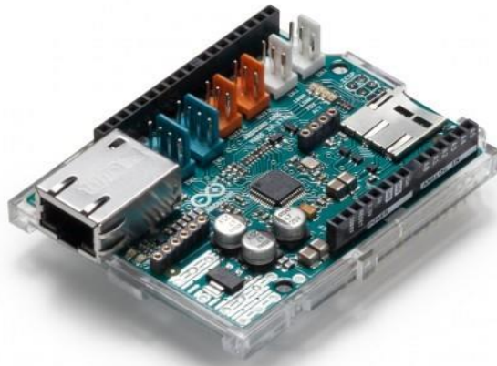
Рис. 4.2 - Контролер Ethernet: W5500
