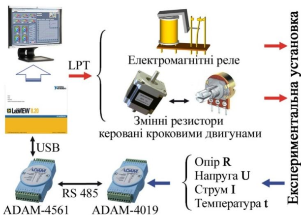
Рисунок 1 – Структурна схема універсального лабораторного стенду
