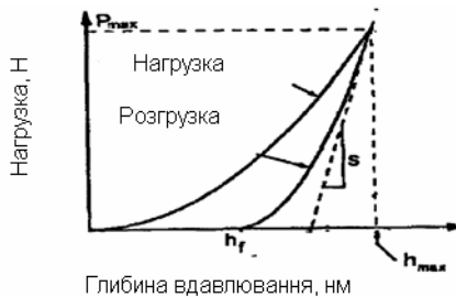
Рисунок 1 – Залежність навантаження від глибини вдавлювання
