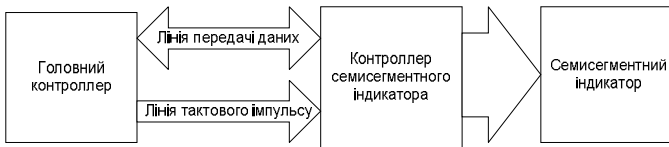
Рисунок 1 – Структурна схема управління семисегментним індикатором через послідовний інтерфейс
