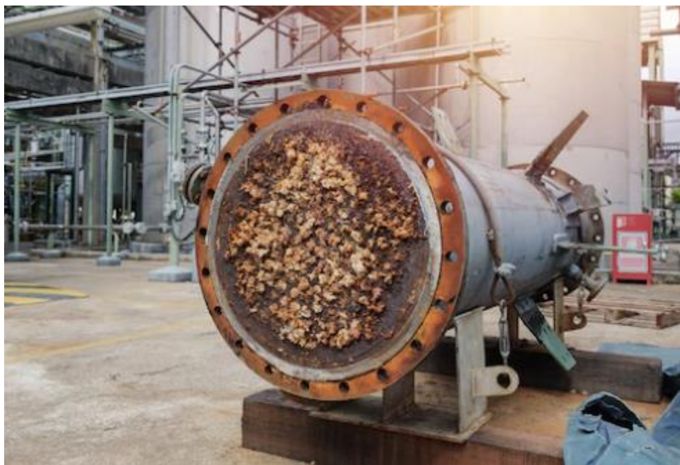
Рисунок 1.13 – Накип та інші відкладення на трубках
