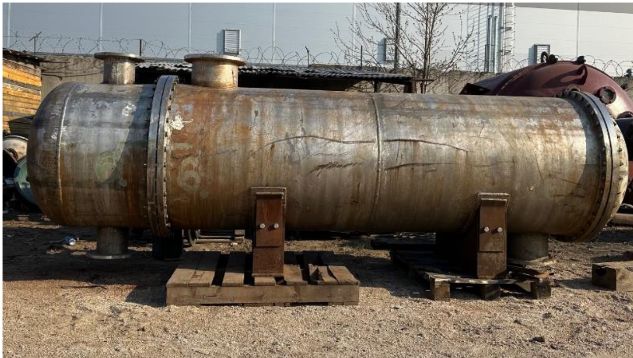
Рисунок 1.11 – Пошкоджений кожух теплообмінника
