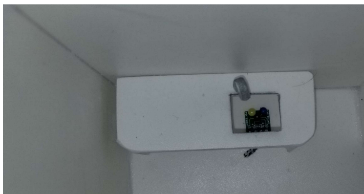
Рисунок 3.22 – Макет раковина з датчиком витоку води
