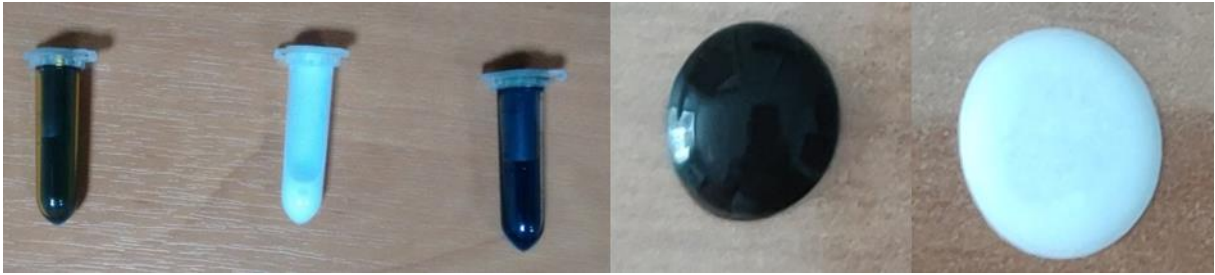
Рисунок 2.6 – Суспензії синтезованих наночастинок \text{Cu}_2\text{ZnSnS}_4 , \text{ZnO} , \text{Cu}_2\text{ZnSnSe}_4 після заміщення ПАР та краплі чорнил \text{Cu}_2\text{ZnSn}(\text{S}_x\text{Se}_{1-x})_4 , \text{ZnO} на підкладці
