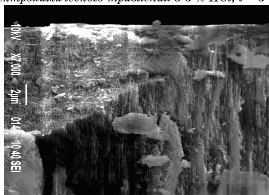
Рис. 7 – Скол пористого n-InP (100), полученного путем электрохимического травления в 5 % HCl, t = 5 мин
