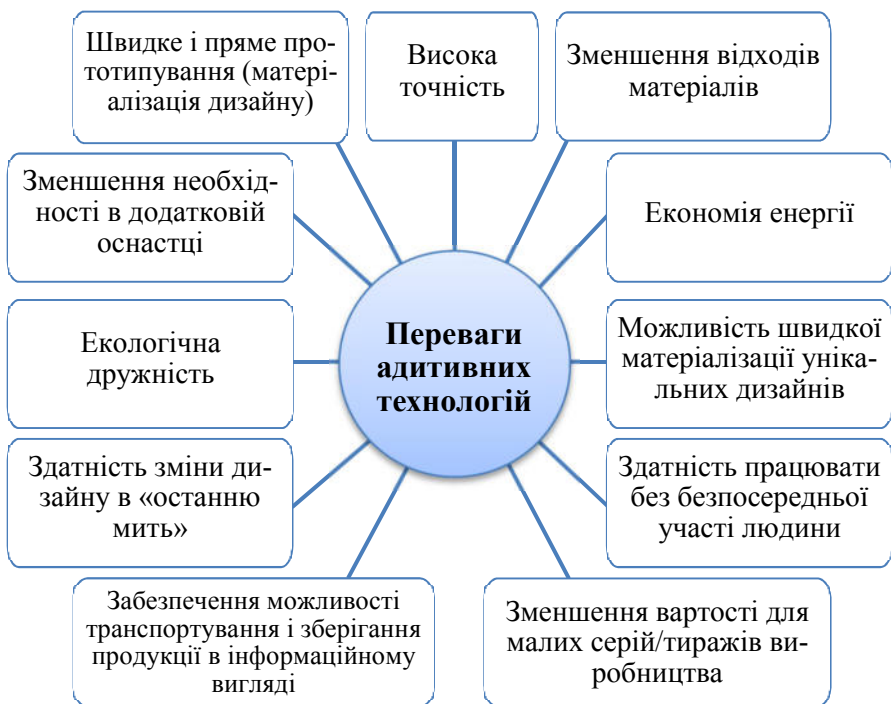
Рисунок 3.3 – Конкурентні переваги адитивних технологій (складено авторами на основі аналізу: May, 2022; Jones, 2023; What, 2023a; Bromberger et al., 2022; Zelinski, 2021)
