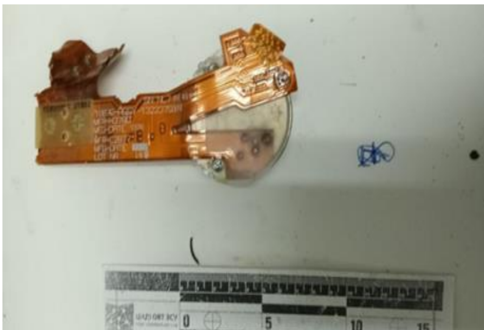
Рисунок 3 Монтажна смужка елемента живлення EAP-12081
