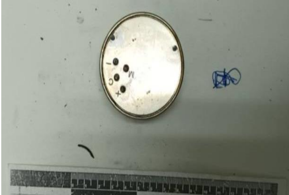
Рисунок 4 Контакти елемента живлення ЕАР-12081
