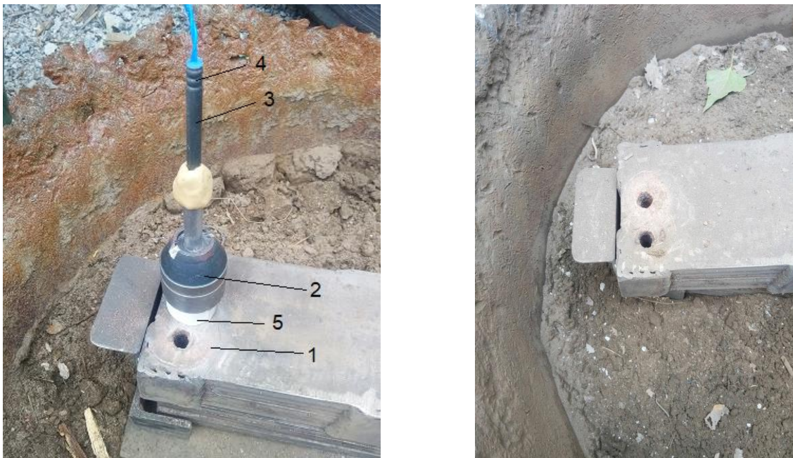
Рисунок 3 Загальний вигляд експериментальної установки до детонації заряду (зліва) та мішень після пострілу (справа); 1- мішень; 2 – кумулятивний заряд; 3 – подовжений заряд в алюмінієвій оболонці; 4 – електродетонатор; 5 - картонний циліндр
