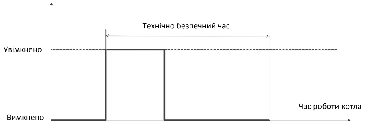
Рисунок 3.4 - Циклограма безпечної роботи котла в дискретному режимі
