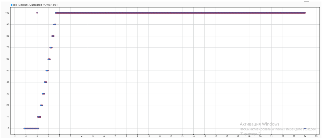
Рисунок 3.7 - Приклад адапційної характеристики для дискретного режиму роботи котла при використанні у якості опорного алгоритму керування ПІД-регулятора з параметрами P=9.8 , I=11 , D=0.1 , N=150 .
