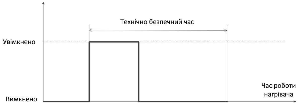
Рисунок 3.4 Циклограма роботи електричного нагрівача в дискретному режимі
