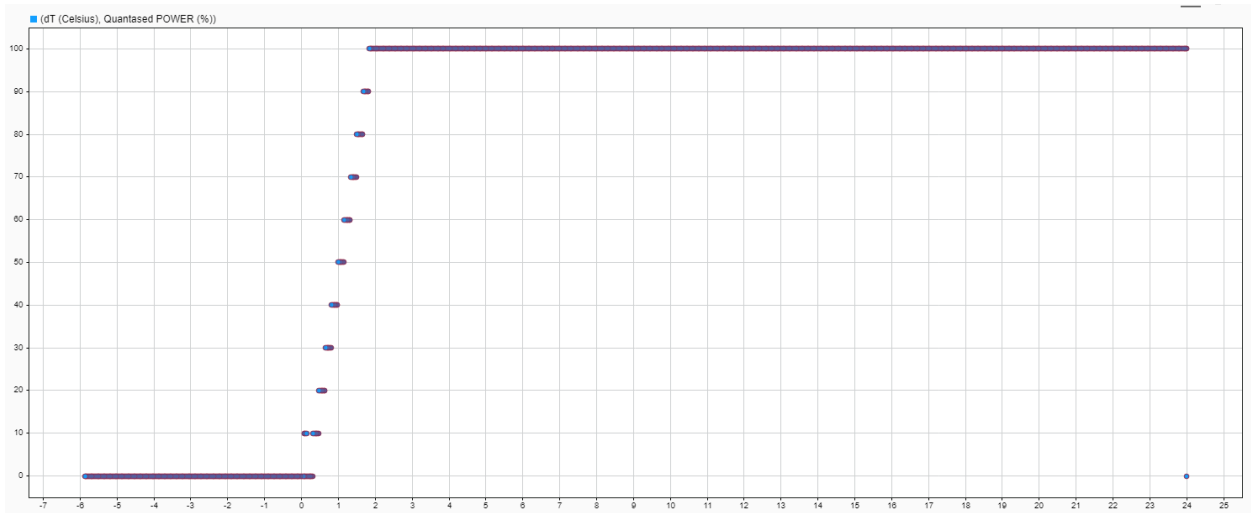
Рисунок 3.7 - Приклад адаптивної характеристики для дискретного режиму роботи котла при використанні у якості опорного алгоритму керування ПІД-регулятора з параметрами P=12 , I=12 , D=0.1 , N=200 .
