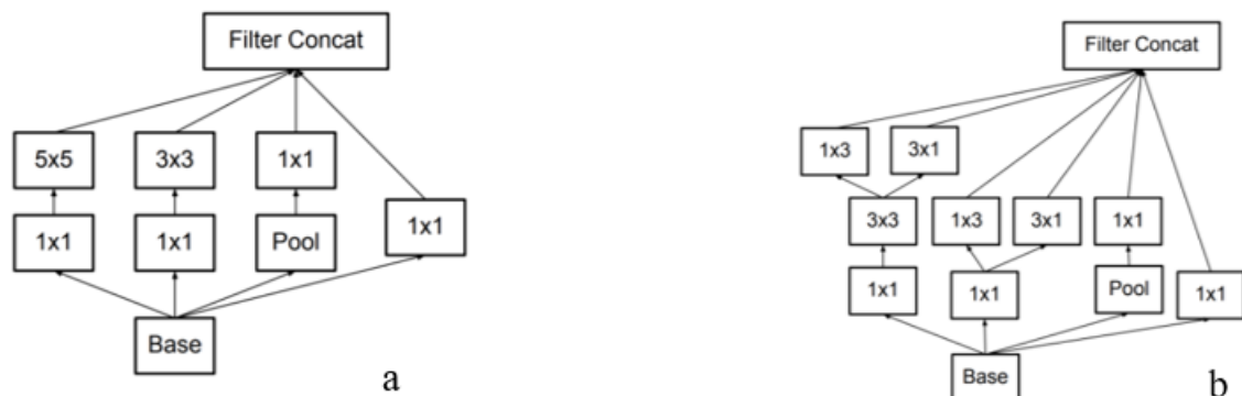
Рисунок 2.8 – а - оригінальний модуль Inception; б - початкові модулі з розширеним банком виходів фільтрів.
