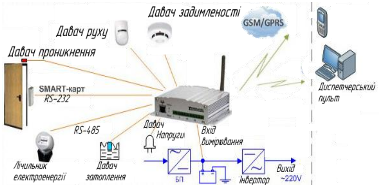
Рис. 10 – Додаткові функції моніторингу стану приміщення БС
