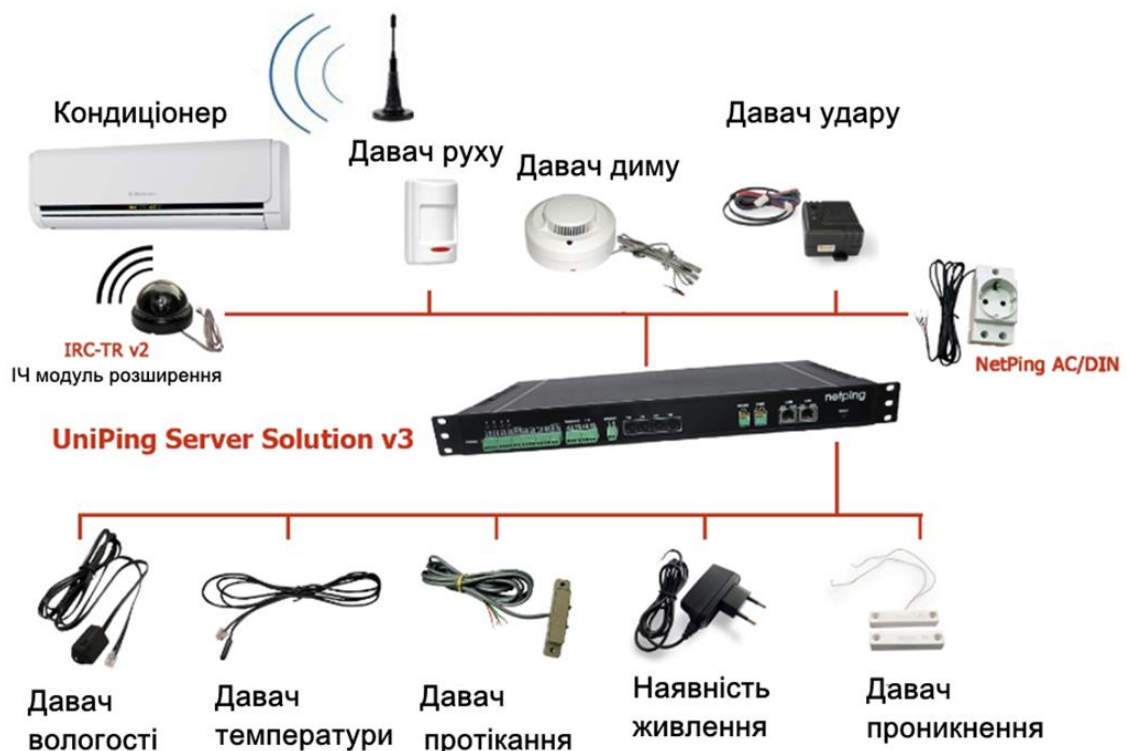
Рис. 27 – Структурна схема системи UniPing server solution v3
