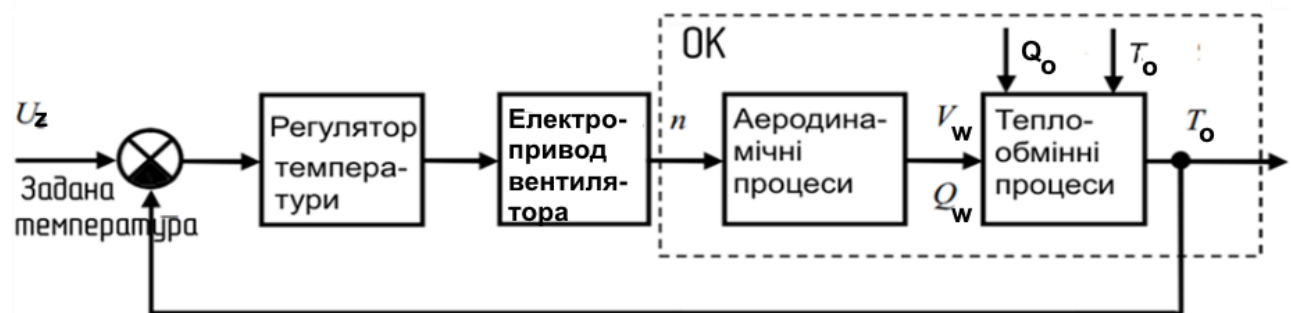
Рис. 23–Структурна схема моделі охолодження
