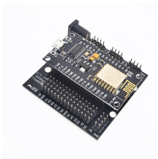
Рисунок 2.1 – Модуль Wi-Fi NodeMCU V3 ESP8266 (iFT232-s16) з'єднаний із платою розширення [20]
