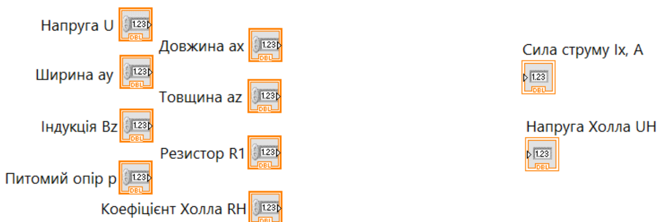
Рисунок 2.2 – Початкова блок-діаграма LabVIEW
