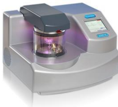
Рисунок 3.2 – Установка для вакуумного напилення Q-150T ES
