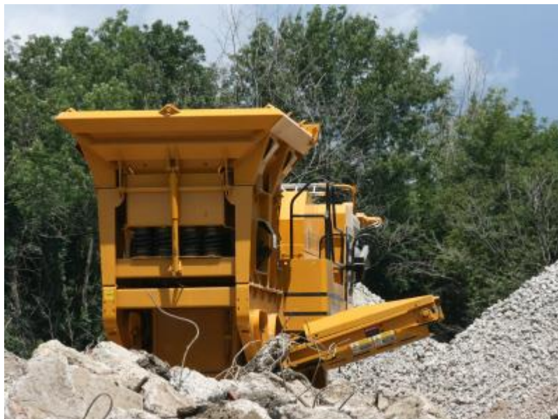
Рисунок 3.1 – Стационарний дробильно-сортувальний комплекс для переробки будівельних відходів
