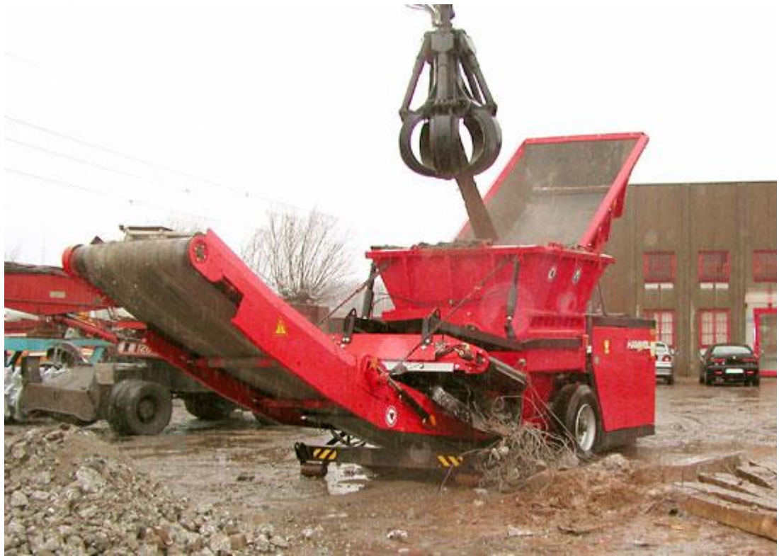
Рисунок 3.2 – Мобільний дробильно-сортувальний комплекс для переробки будівельних відходів
