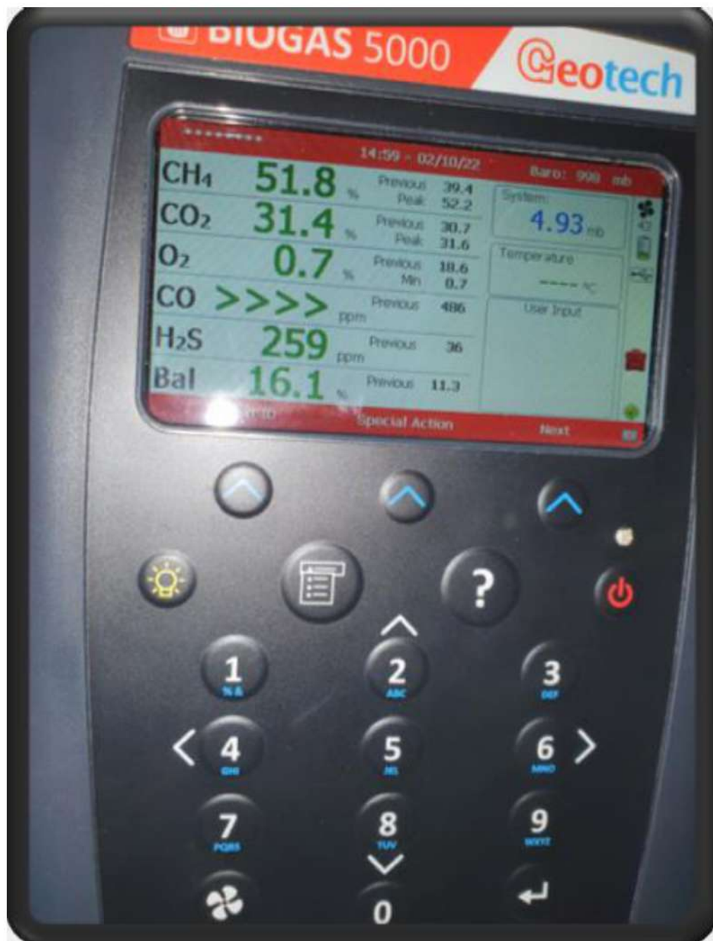
Рисунок 3.4 – Процес аналізу біогазу газоаналізатором BioGas 5000
