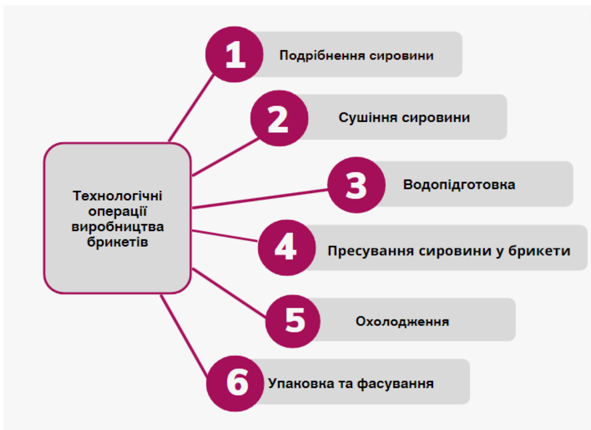
Рисунок 3.2 – Блок-схема технологічних операцій з виробництва паливних брикетів
