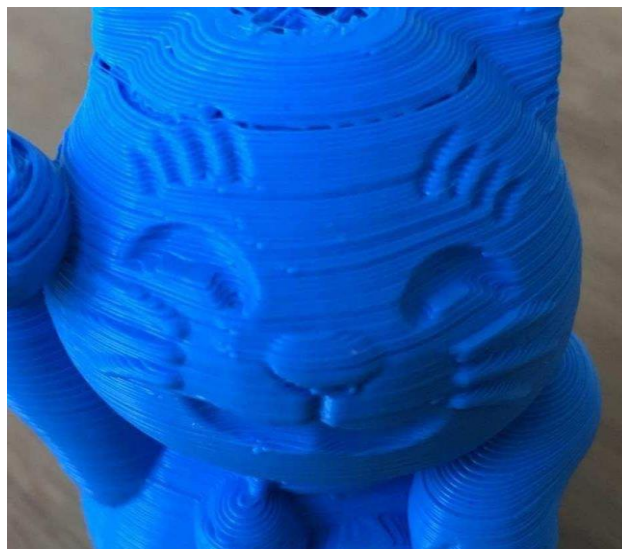
Рисунок 1.9 – Тріщини у високих об'єктах
