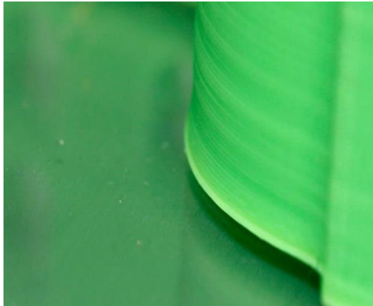
Рисунок 1.8 – Зміщення першого шару
