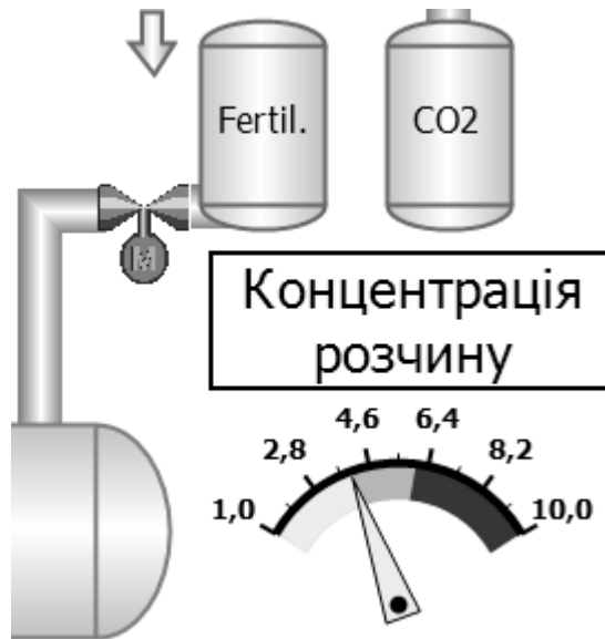
Рисунок 34 - При недостатньому рівні, відкривається запірна арматура до концентрованого розчину добрив
