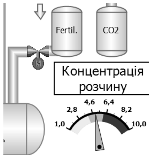
Рисунок 35 - При оптимальному рівні, закривається запірна арматура до концентрованого розчину добрив
