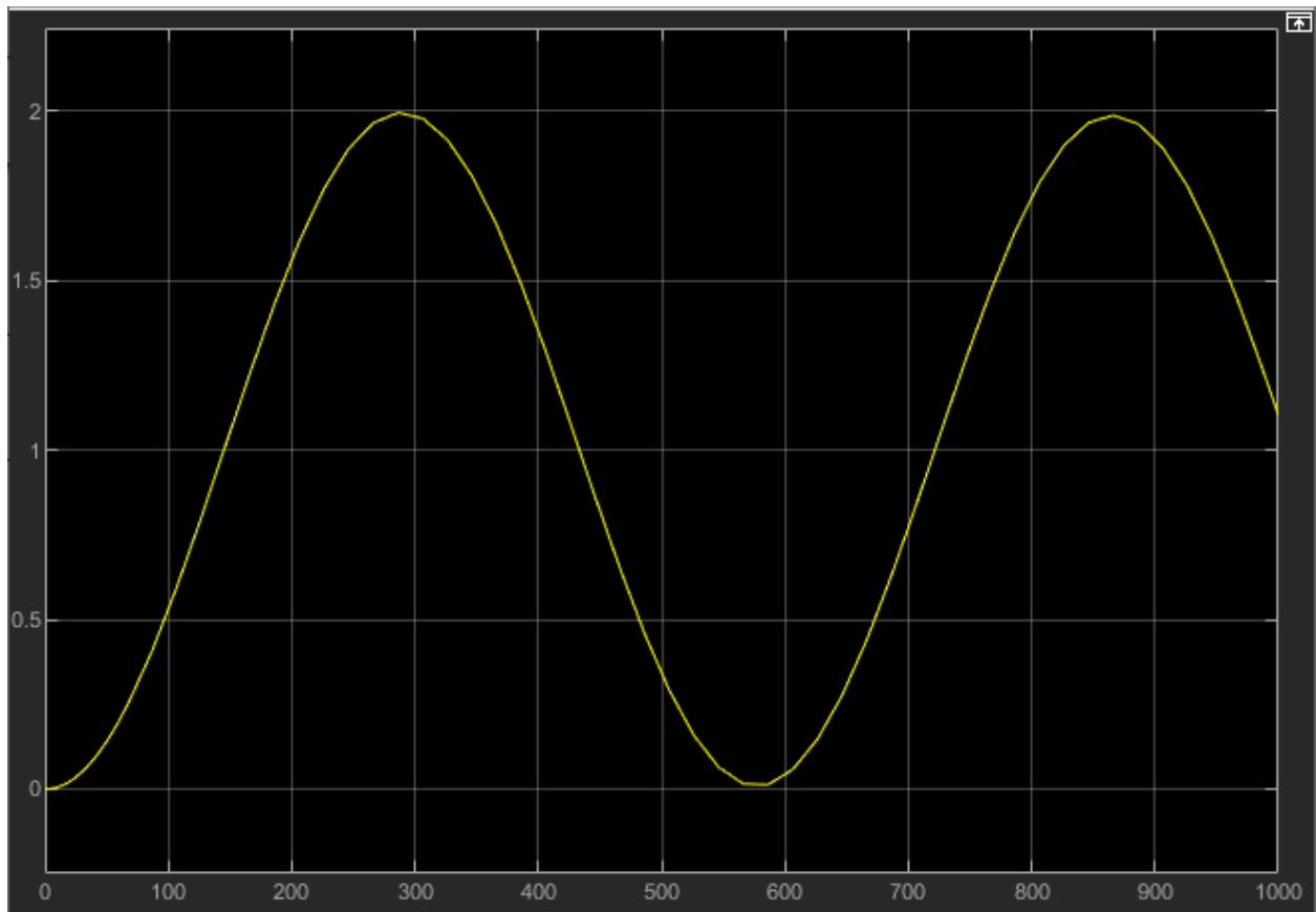
Рисунок 19 – Графік при не налаштованому ПІД регулятору
