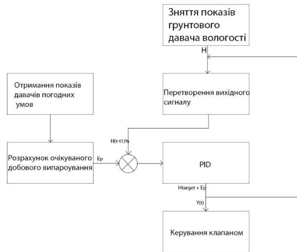
Рисунок 2 – Алгоритм роботи системи прогнозованого керування поливом газону
