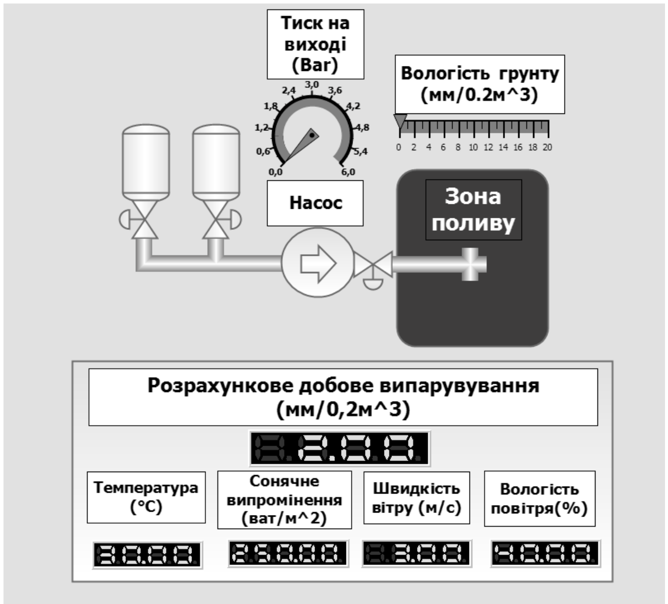
Рисунок 16 – SCADA система прогнозованого керування поливом На даній SCADA системі зображено наступні контури керування:
