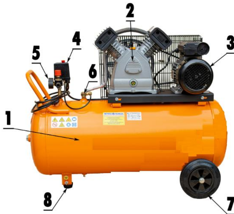
Рисунок 1.4 - Принципова схема поршневого компресорної установки
