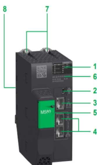
Рисунок 31 – Опис програмного контролера Modicon M580 BMEP5810
