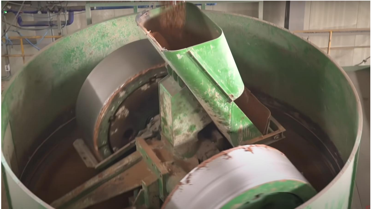
Рисунок 2.3 - Гранулятор в стрижневому змішувачі
