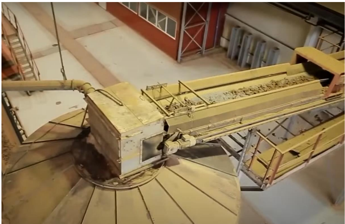
Рисунок 2.1 - Агрегат завантаження сировини
