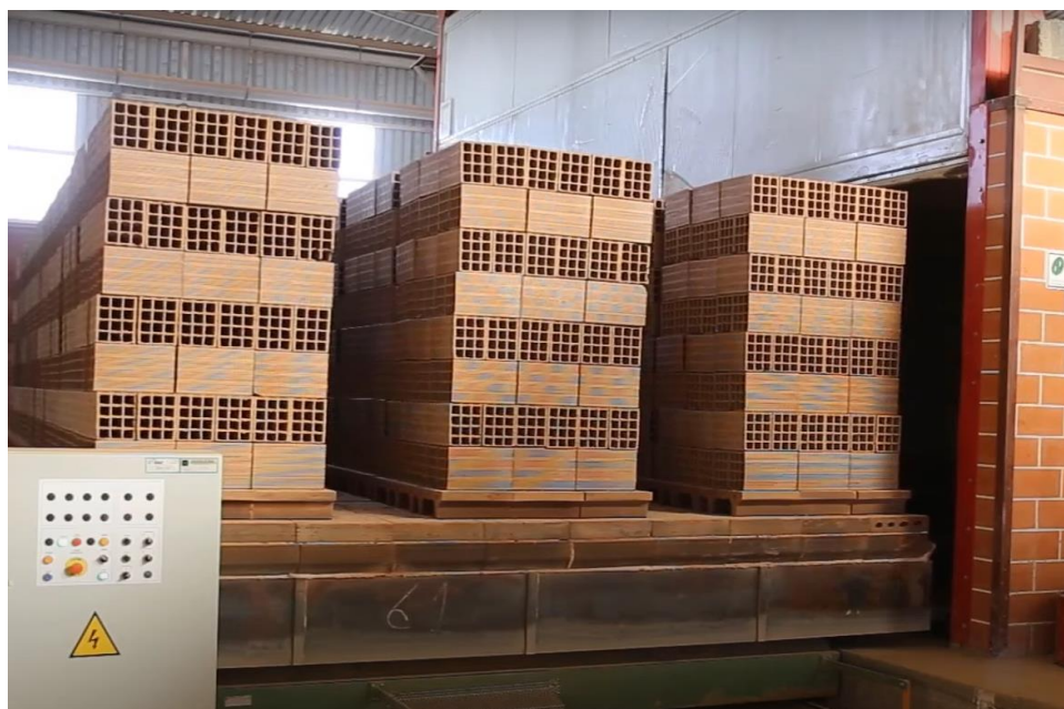
Рисунок 2.10 - Завантаження цегли в піч для проведення випалу
