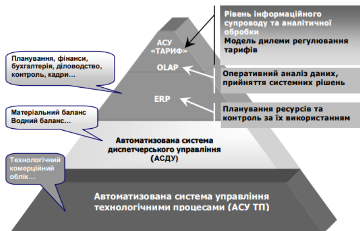
Рисунок 3.7 – Автоматизована структура управління водопостачанням і водовідведенням (Анпілогов, П. І., Михайленко, В. М., & Кириченко, С. Д., 2008)
