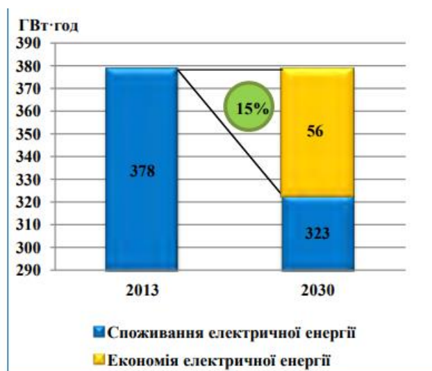
Рисунок 3.3 – Зниження споживання електричної енергії в системі водопостачання та водовідведення
