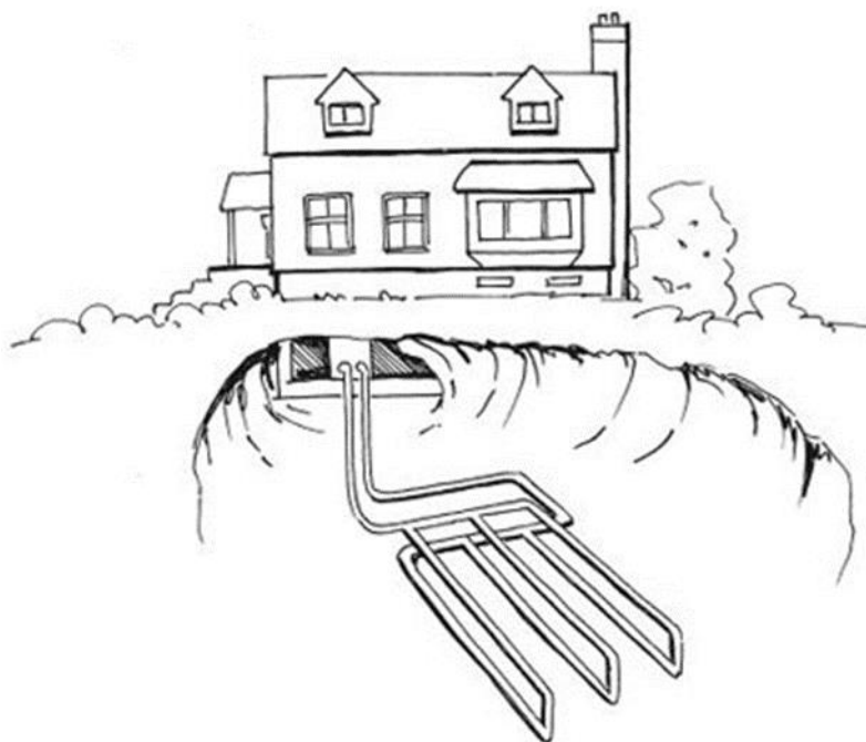
Рисунок 4 – Розташування геотермального теплового насосу
