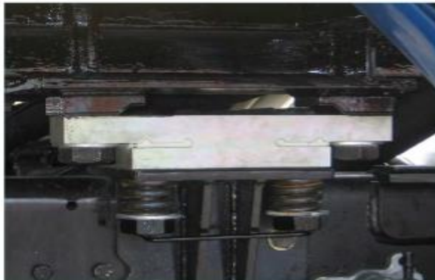
Рисунок 1.7 – Встановлений тензодатчик між кузовом та рамою автомобіля.
