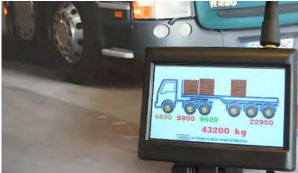
Рисунок 2.1 - Статичне бортове зважування
