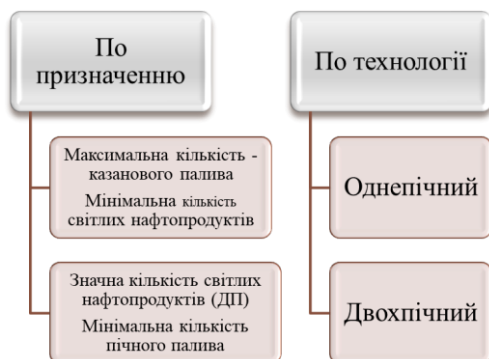
Рисунок 7.11 – Залежність способу проведення вісбрекінгу від призначення та технології
