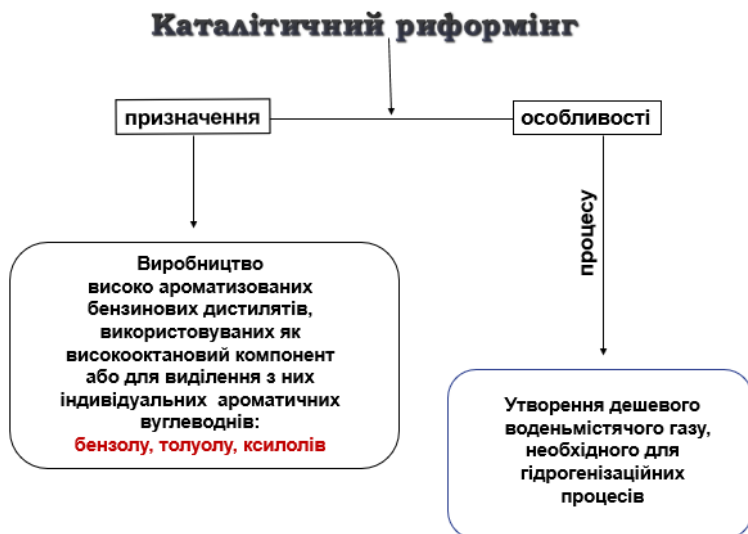
Рисунок 11.1 – Призначення та особливості процесу каталітичного риформінгу
