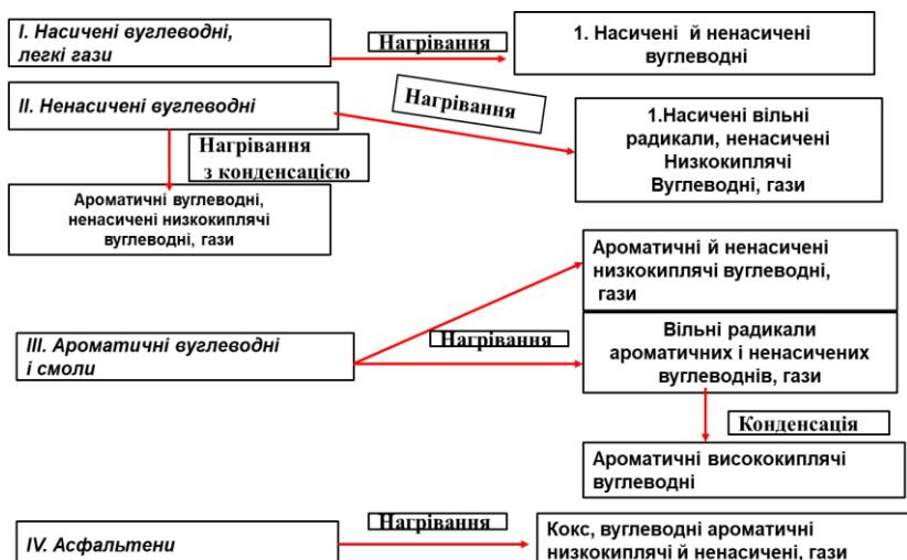
Рисунок 6.6 – Схеми перетворень вуглеводнів за технологією термокрекінгу
