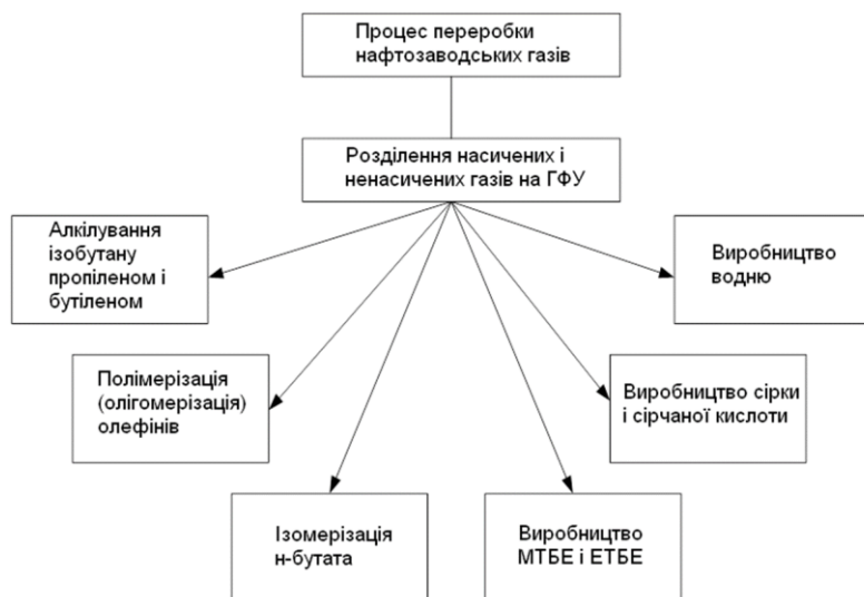
Рисунок 19.2 – Процес перероблення нафтозаводських газів (МТБЕ – ефір метил-трет-бутиловий; ЕТБЕ – етил-трет-бутиловий ефір)
