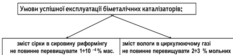
Рисунок 11.7 – Умови успішної експлуатації біметалічних каталізаторів
