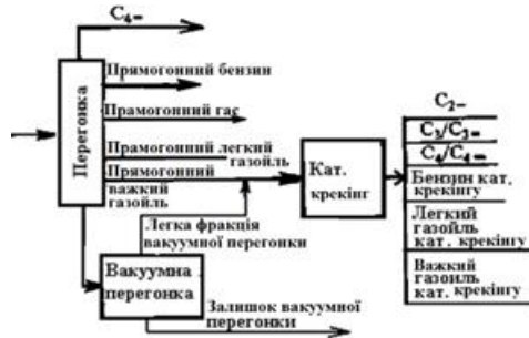
Рисунок 9.12 – Технологічна схема нафтоперероблення з установкою КК
