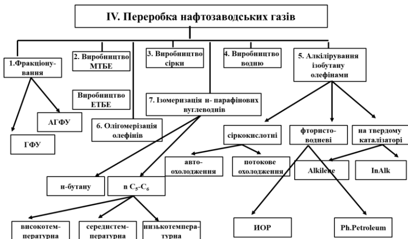
Рисунок 6.5 – Схематичний зв'язок між різними способами перероблення вторинних нафтових газів, що з'явилися на заводі внаслідок перероблення нафти
