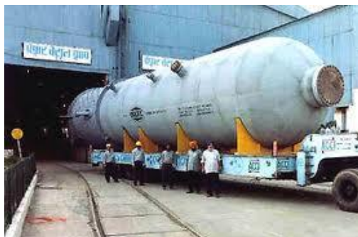
Рисунок 12.9 – Реактор гідроочищення дизельного палива (130 т)
