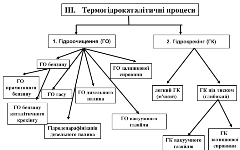
Рисунок 6.4 – Схематичний зв'язок між різновидами термогідрогенізаційних процесів
