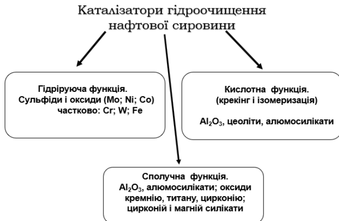
Рисунок 12.5 – Складові каталізаторів гідроочищення
