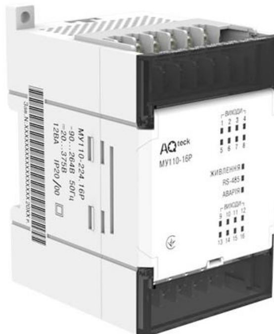
Рисунок 3.5 - МУ110-16Р. Модуль дискретного виводу
