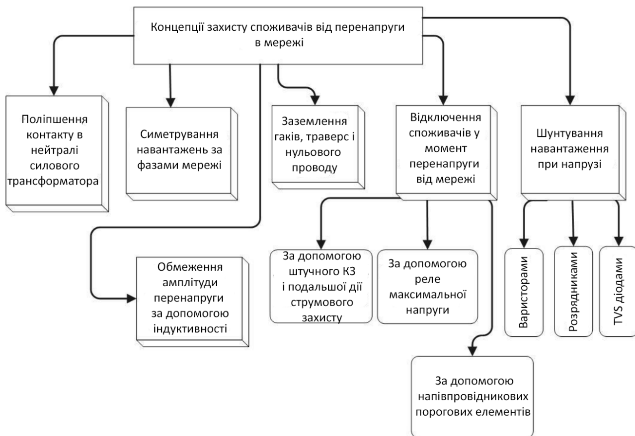
Рисунок 1.3 – Класифікація концепцій захисту електроспоживачів від перенапруги в мережі
