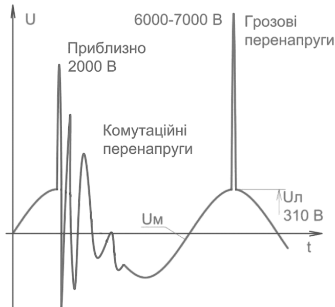
Рисунок 2.2 – Приклад грозових(зовнішніх) та комутаційних(внутрішніх) імпульсних перенапруг
