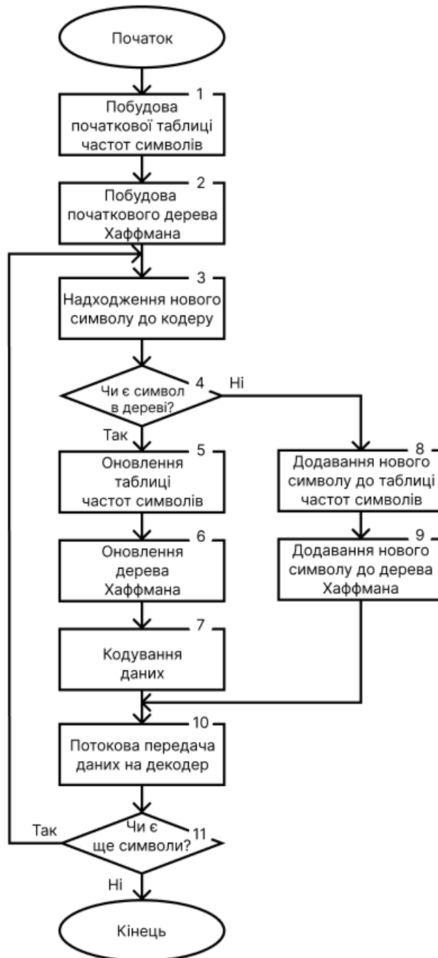
Рисунок 3.4 – Алгоритм роботи пристрою стиснення
