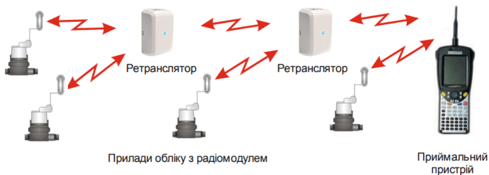
Рисунок 1.5 – Передача по радіоканалу із застосуванням ретрансляторів
