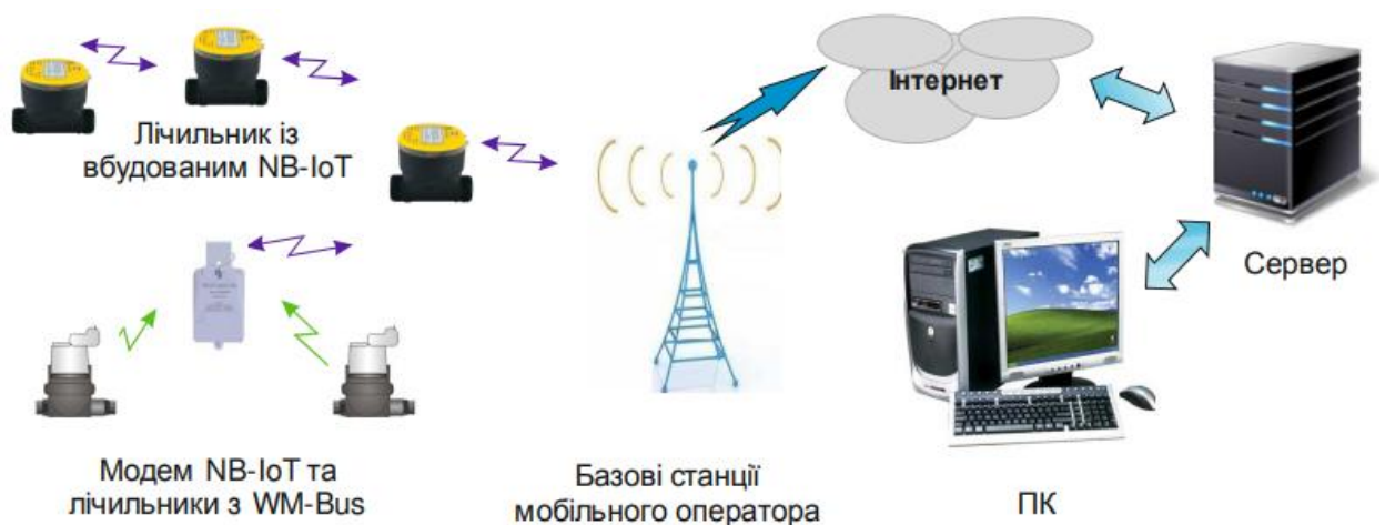
Рисунок 1.7 – Структура мережі із застосуванням технології NB-IoT
