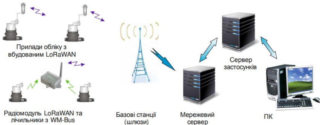
Рисунок 1.6 – Структура мережі із застосуванням технології LoRaWAN
