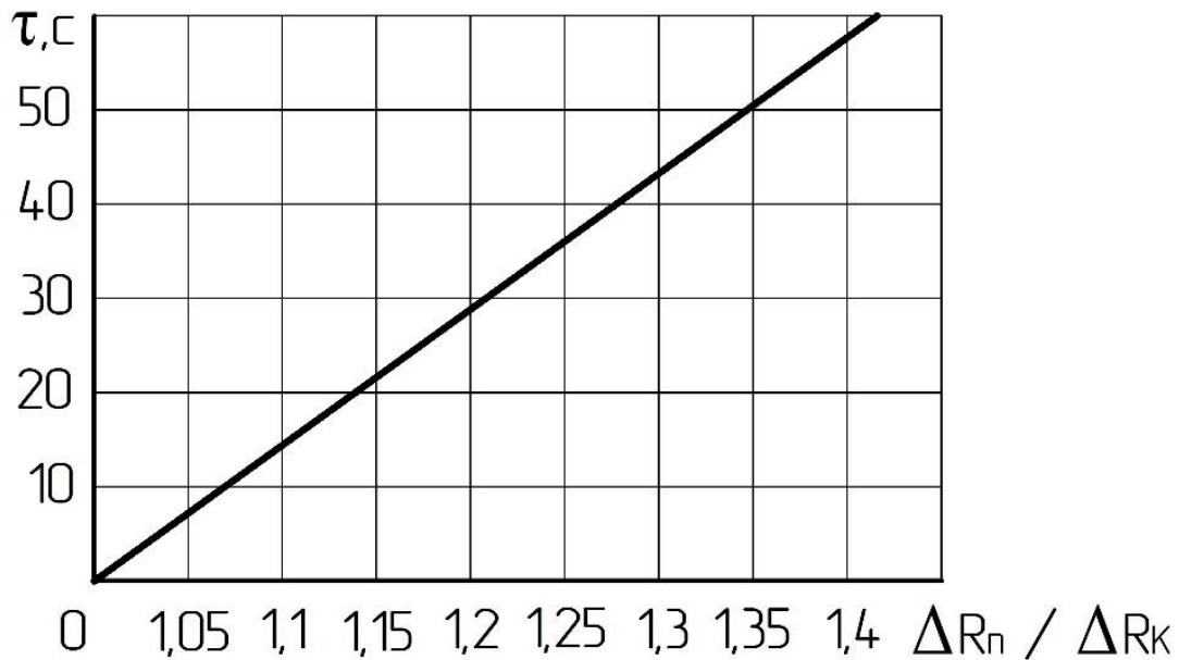
Рисунок 3.6 – Час усунення похибки форми циліндричної поверхні (круглості) при коефіцієнті жорсткості \gamma=1500 кг/мм
