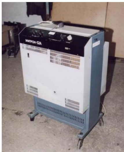
Рисунок 2.1 – Установка «Елітрон-52А», призначена для чистового і грубого ЕІЛ
