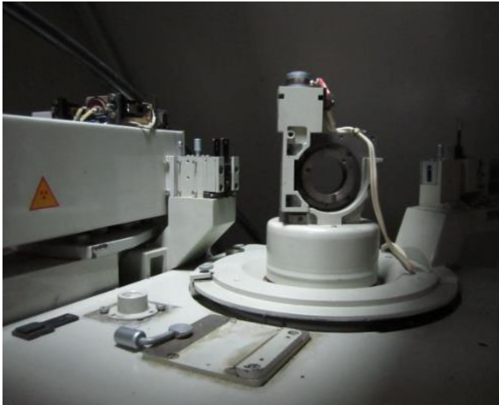
Рисунок 2.5 – Зображення Дифрактометр рентгенівський ДРОН-3
