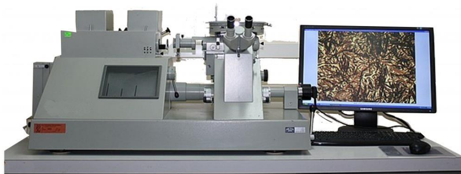
Рисунок 2.3 Фото оптичного металографічного мікроскопу Neophot 2
