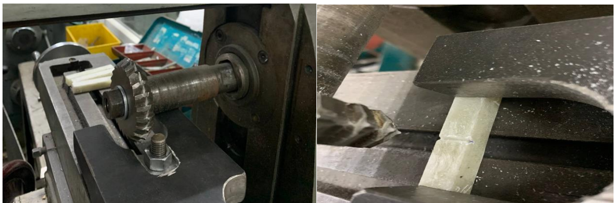
Рисунок 2.8 Фреза та переріз на заготовці
