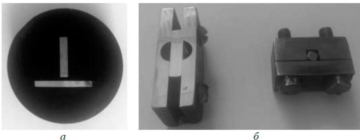
Рисунок 2.1 – Засоби фіксації зразків малих розмірів при пробопідготовці до металографічних досліджень:
