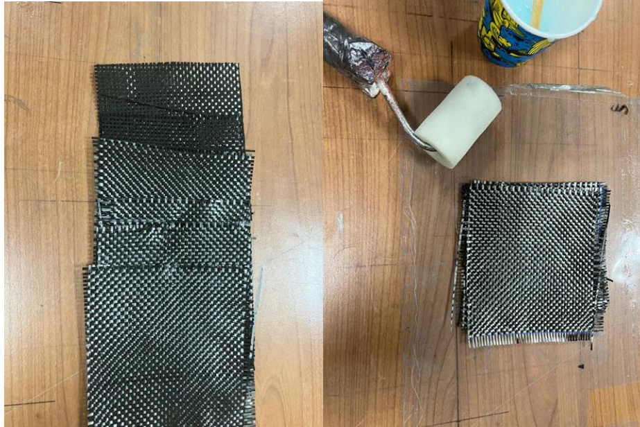
Рисунок 3.1 – Приготування зразків: а) розкроєні зразки тканого матеріалу; б) просочення матеріалу епоксидною смолою паралоновим валиком.
