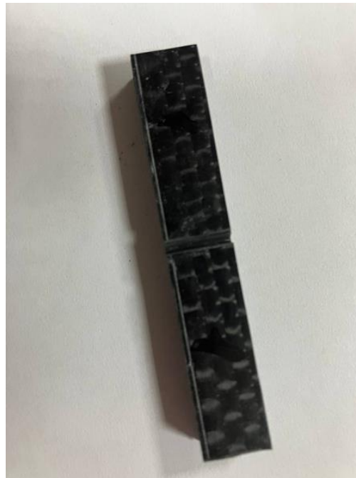
Рисунок 3.6 - Зразок з надрізом типу–А для проведення випробувань з визначення ударної в'язкості.
