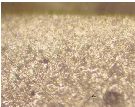
Рисунок 3.10 - Структура після нітроцементатації в пастах (70 % гексаціаноферрата калію, 20 % деревного вугілля, 10 % вуглекислого барію, 5-10 % етил силікати) + СВЧ, \times 200
