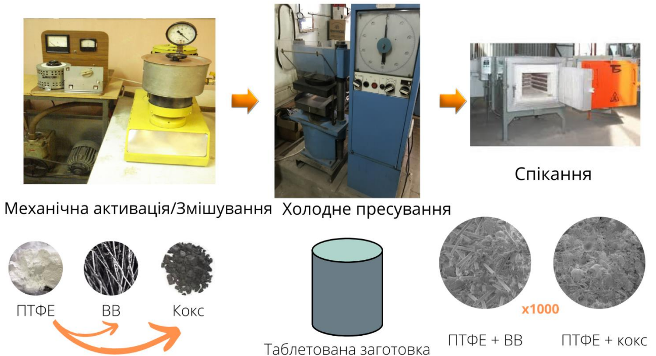
Рисунок 2.1. Схема технології виробництва зразків для випробування.
