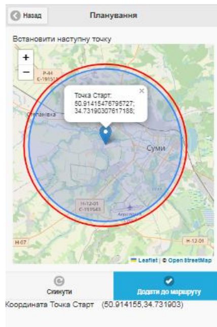
Рисунок 4.8 - Макет екрану планування: відображення зони майбутнього польоту
