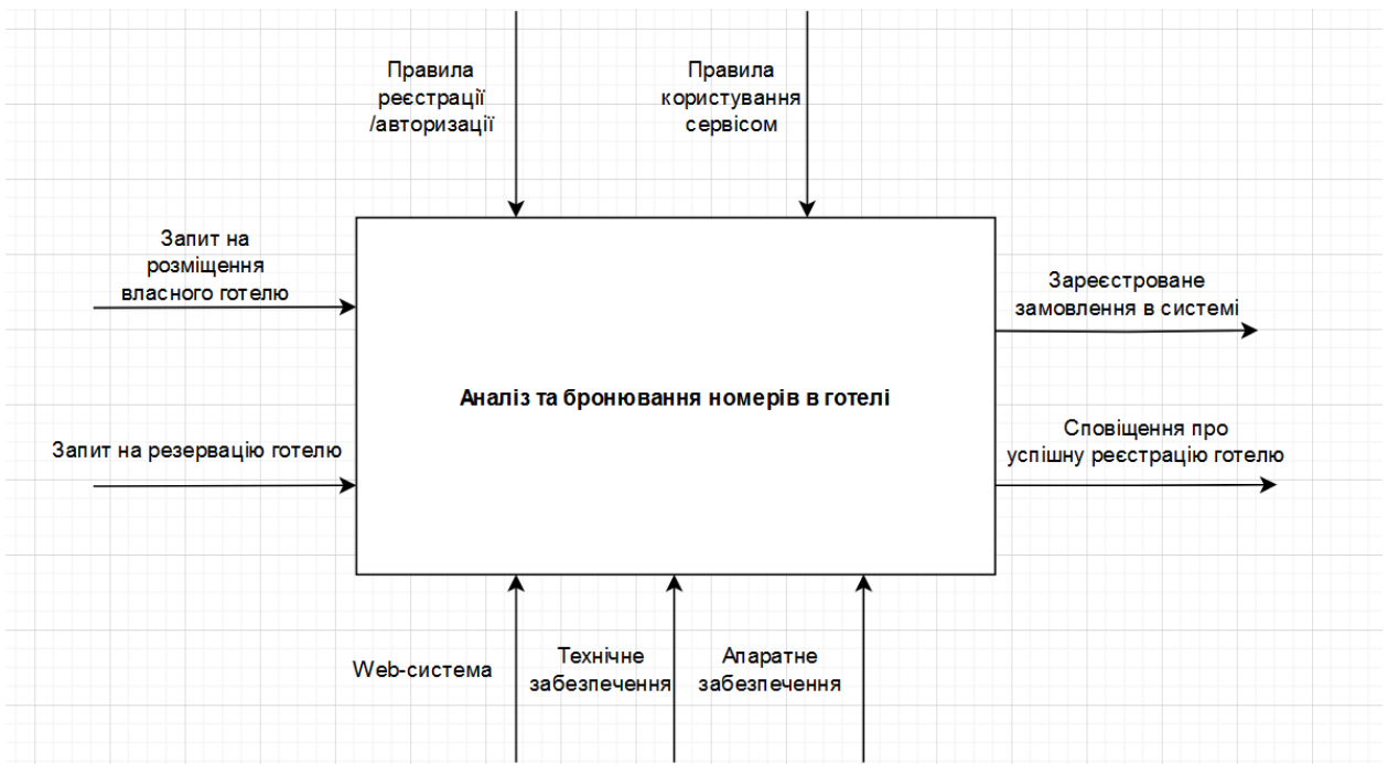
Рисунок 3.1 – Контекстна діаграма в нотації IDEF0 для веб-орієнтованої системи аналізу та бронювання номерів в готелі.
