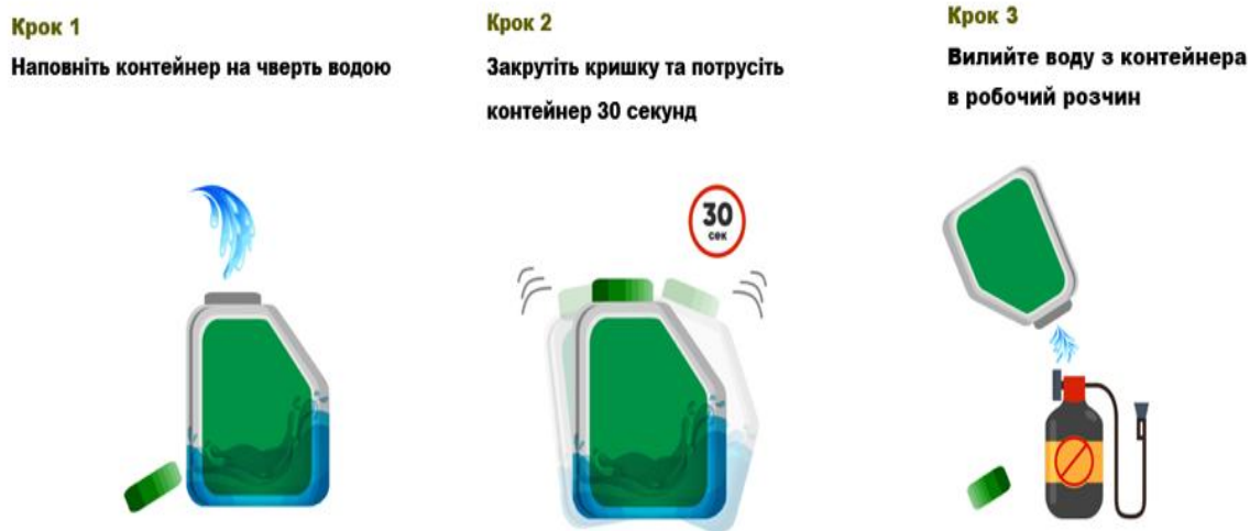
Рисунок 1.3 – Етапи проведення потрійного промивання тари з-від ЗЗР [30]
