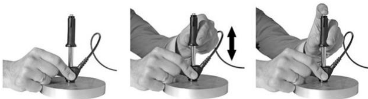
Рисунок 2.3 – Вимірювання ударним перетворювачем типу В
