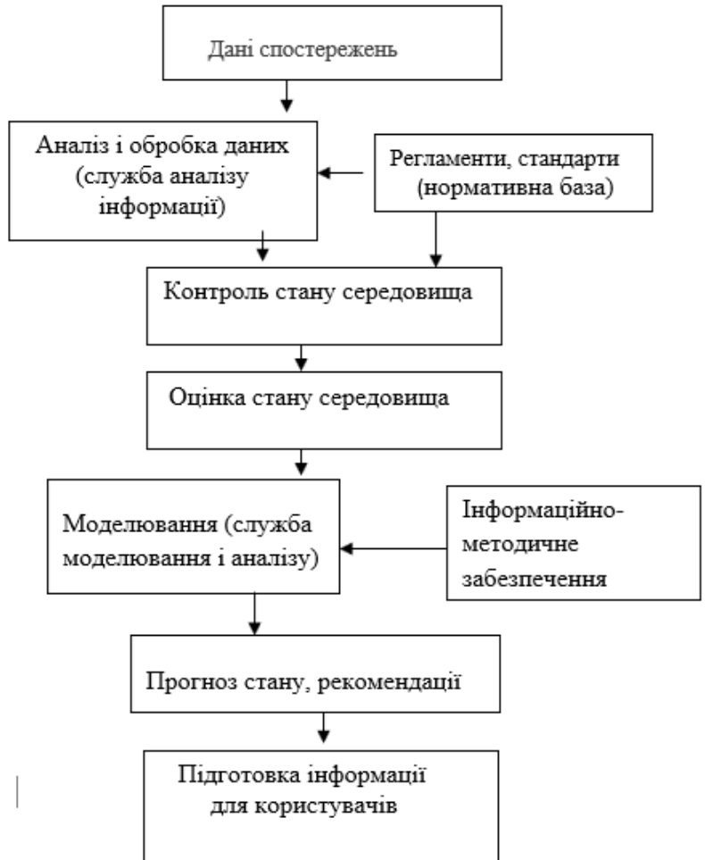
Рисунок 1.2 – Типова функціональна схема моніторингу
