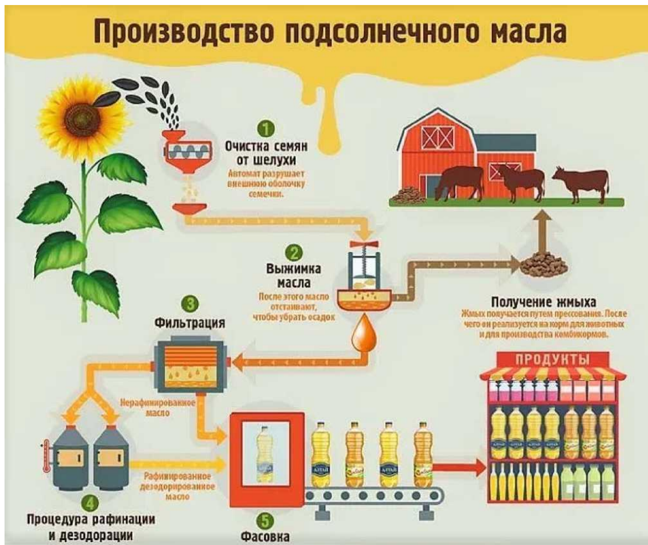
Рисунок 1.2 - Коротка схема технології виробництва рослинного масла
