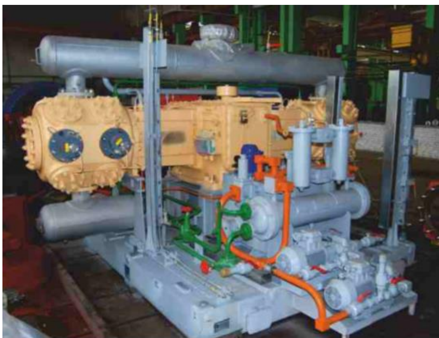
Рисунок 1.1 – Компресорна установка на базі 2ГМ10А
